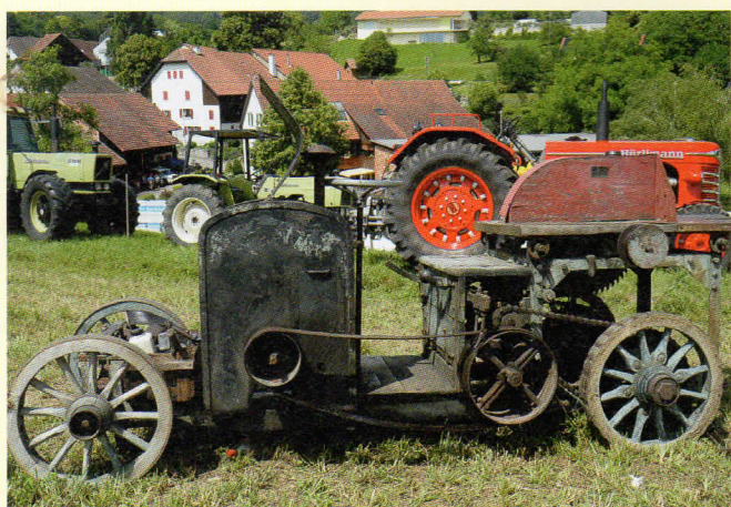
Selbstfahrende Brennholzfräse von Lüthi.
